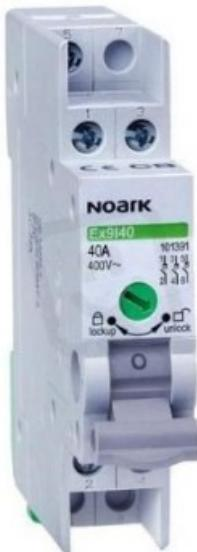
Leistungsschalter der Serie Ex9I40 eignen sich als Hauptschalter für vielfältige Anwendungen. Diese Leistungsschalter sind nach IEC/ČSN EN 60947-3 geprüft und erfüllen die Anforderungen an sicheres Trennen. Die Gebrauchskategorie AC-22A garantiert das Schalten gemischter ohmscher und induktiver Last...
