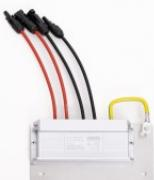
Aufgrund der gesetzlichen Verpflichtung, Überspannungsableiter der Klasse 1 in der Nähe der ins Gebäude führenden Stringleitungen zu platzieren, führen wir eine neue Modellreihe von SPD-Einheiten zur Montage auf der Tragstruktur der Photovoltaikmodule selbst ein. Die eigentliche Konstruktion besteht...
