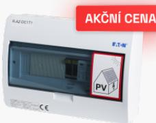
DC-Schalttafel in Schutzklasse 1+2 für die Wandmontage, IP40, dient als Eingangsschalttafel von den Photovoltaikmodulen (zum Wechselrichter) für das gesamte Portfolio an Photovoltaik-Kraftwerken. Die Schaltanlage ist mit einem DC-Überspannungsableiter mit Sicherungstrennschaltern einschließlich gPV-...
