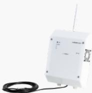
Die Steuereinheit DRP-3SL enthält Kommunikations-, Überwachungs- und Steuerschaltungen sowie Leistungselemente für ein- bis dreiphasige Geräte. Das Gerät ist mit einer aktiven Kühlung ausgestattet, um einen Temperaturanstieg der Schaltelemente zu verhindern. Bei Überhitzung sind Sicherungen installiert...
